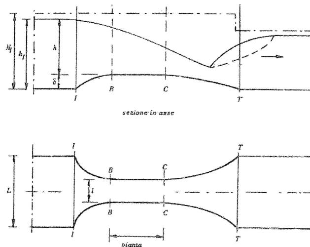
Discutendo il venturimetro per canali si è ovviamente introdotto anche il concetto di stato critico, ossia quello stato in cui, data una certa portata costante, vi corrisponde una certa altezza idrica  $h_c$  detta critica in corrispondenza della quale si ha la minima energia specifica per unità di peso, come si può evincere dal seguente grafico:
