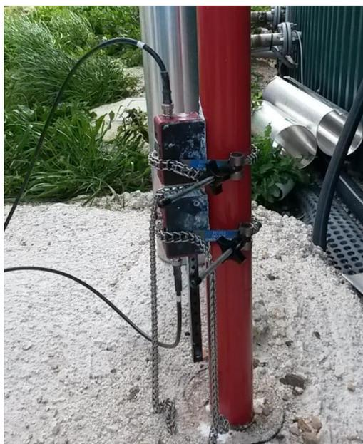
Figura 6 Set-up sperimentale per la misura della portata d'acqua che alimenta il digestore
