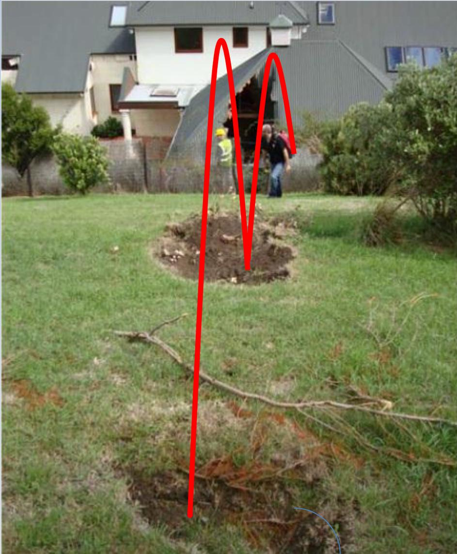
Consiste nella calibrazione dei più opportuni coefficienti di restituzione all'urto e degli altri parametri da adottare nelle verifiche, al fine di simulare in maniera realistica le effettive traiettorie di caduta riconosciute in sito.
