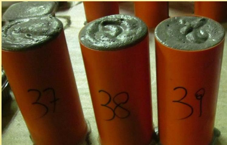
i provini realizzati con pressione di schiuma 3 bar allo stato fresco lasciano intravedere una struttura caratterizzata da un volume maggiore e un numero maggiore di pori, e una densità minore.
