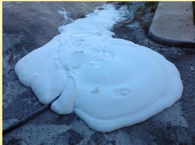
Le prove sono state eseguite utilizzando agente schiumogeno ISOLTECH con una concentrazione rispetto all'acqua pari a 2,5 g/l. Sono stati fatti variare di volta in volta pressione dell'aria insufflata all'interno della miscela fluida composta da acqua e agente schiumogeno preformato, e la portata di acqua.
