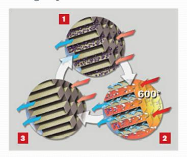
Per ripristinare la capacità di filtrazione del dispositivo è necessario procedere con la RIGENERAZIONE del filtro
