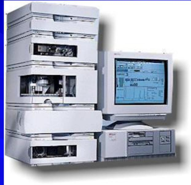
**I campioni prelevati vengono sottoposti ad analisi mediante cromatografia liquida ad alta pressione (HPLC)**
