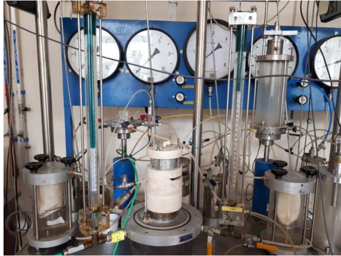
Figura 1:permeometro a carico costante
