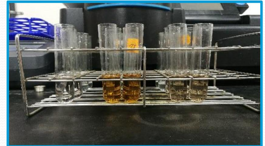
Raccolta campioni di fango (20 ml) nel reattore e sulla membrana per l'analisi della comunità microbiologica
