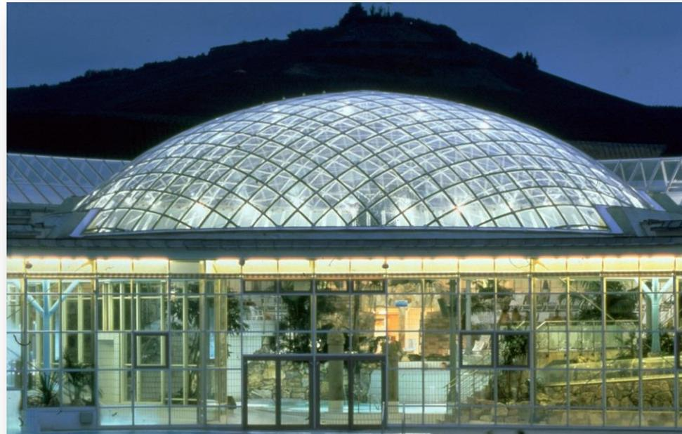
Grid shells, strutture di barre curve, soggette a instabilità locale di snap through
