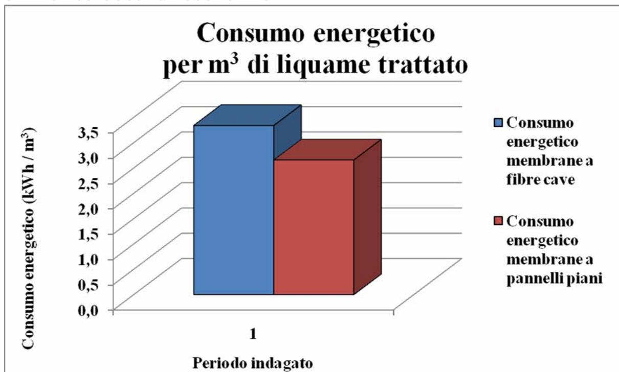
Tale grafico mette in evidenza come le membrane a fibre cave abbiano un consumo specifico per m<sup>3</sup> di liquame trattato più elevato rispetto al consumo specifico delle membrane a pannelli piani. Il valore di 3,34 kWh/m<sup>3</sup> del consumo specifico delle membrane a fibre cave, è il 20% in più rispetto ai 2,66 kWh/m<sup>3</sup> delle membrane a fibre piane.
