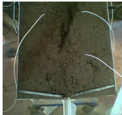
**Fig. 3:** *Particolare del pendio alla fine della prova con rete di protezione, prima e dopo la rimozione della rete*
