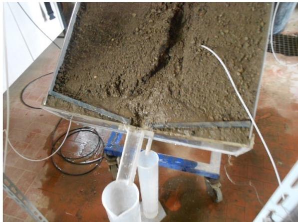
**Fig. 2:** *Particolare del pendio alla fine della prova con 10 minuti di pioggia*
