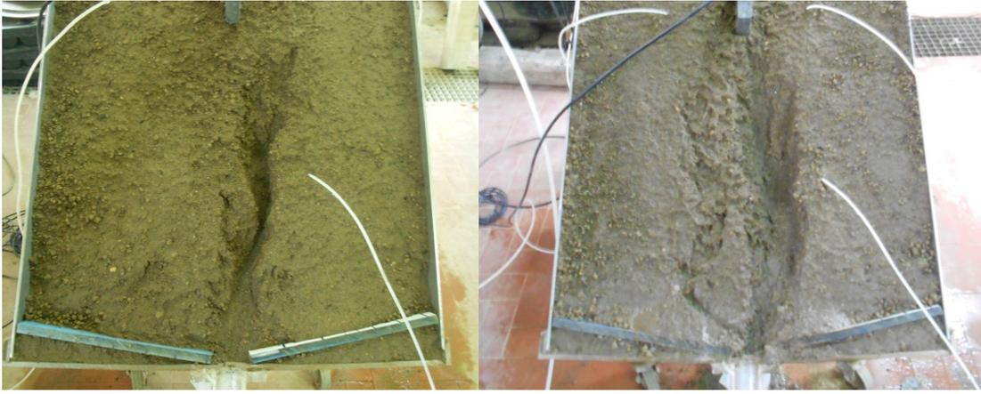
**Fig. 1:** *Particolare del pendio alla fine delle due prove con 3 minuti di pioggia*
