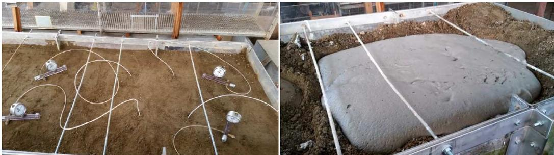
La strumentazione di misura utilizzata è composta da un misuratore elettronico di pressione a monte, un misuratore di portata a monte e a valle per stimare la portata idrica persa e, nel caso della prova con rinterro di sabbia, da 4 tensiometri per misurare la suzione a monte e a valle della perdita, al di sopra e al di sotto della condotta.
