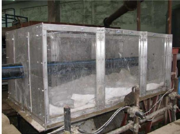
Sono state eseguite due prove, una di riferimento con rinterro di materiale ordinario (piroclastite) ed una con rinterro con CLS cellulare.
