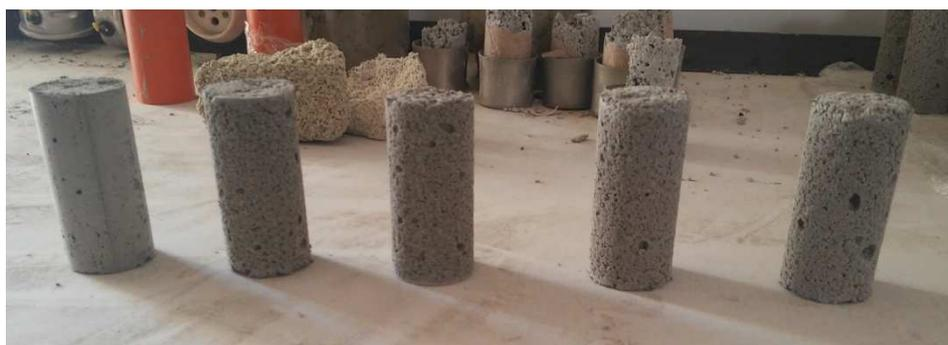
È stata quindi preparata la macchina di colonna risonante. Il provino è stato incastrato alla base incollandolo con una resina bicomponente.
