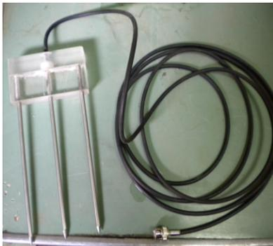
TDR. La riflettometria nel dominio del tempo (TDR) è il metodo indiretto maggiormente utilizzato per la stima del contenuto di acqua in sito, in quanto è non distruttivo e poco invasivo. Tale tecnica si basa sulla propagazione delle onde elettromagnetiche nel terreno; in particolare tramite la stima della costante dielettrica del terreno stesso è possibile
