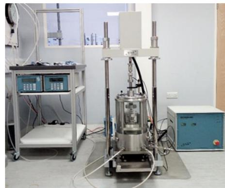
Figura 1.4 – Apparecchiatura di taglio semplice (CSS)
