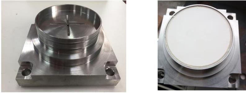
Figura 1.10 – Piastre ceramiche per condurre prove non sature
