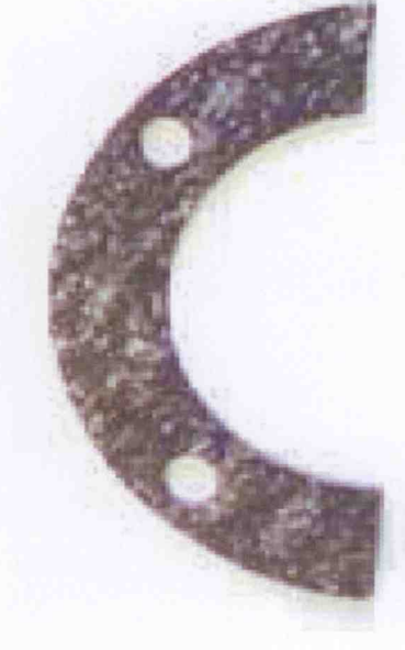
Guarnizione con amianto
