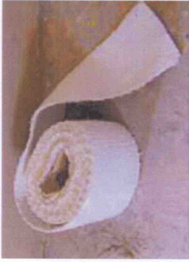
Nastro in tessuto di amianto
