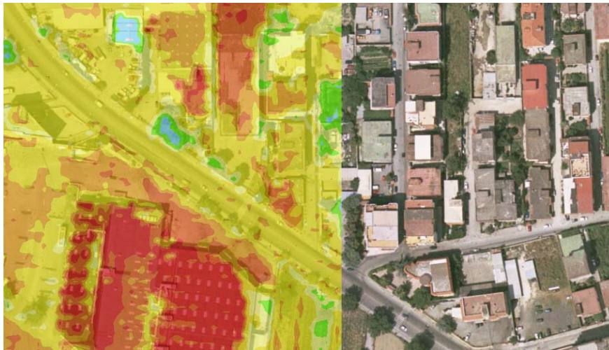
Figura 3 Dettaglio della sovrapposizione della termografia alla ortofoto digitale
