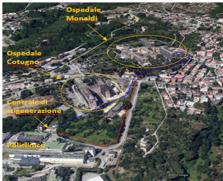
Figura 3: Possibili percorsi per la rete di teleriscaldamento
