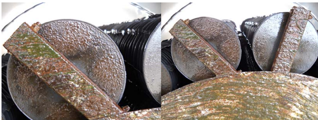
Figura 1 Biofilm adeso alla superficie dei dischetti costituenti il rotore biologico.
