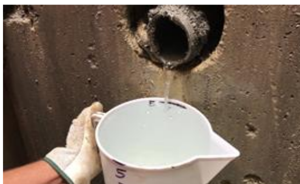
Figura 3 – Operazioni di misura della portata delle aste drenanti
