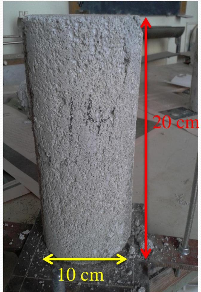
Provino con contenuto di cemento di  $270 \text{ kg/m}^3$
