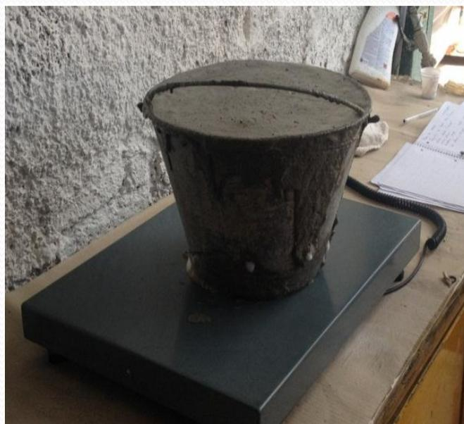
Miscela fresca e spandimento dell'impasto con contenuto di cemento pari a  $270 \text{ kg/m}^3$  :
