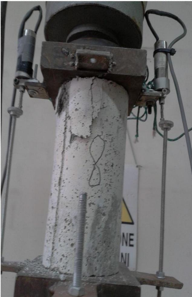
Provino con contenuto di cemento di  $360 \text{ kg/m}^3$
