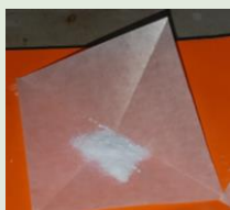
Zeolite 60-80 0.241 < D < 0.178 mm
