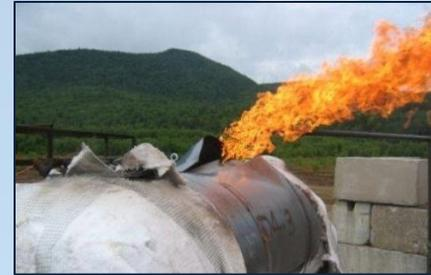
↪ Esempio di stima degli effetti termici di un getto di fuoco in seguito a rilascio biogas per rottura catastrofica tubo
