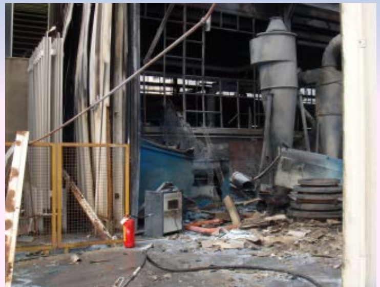
Esplosione da polveri metalliche presso la Nicomax di Gravellona Toce (VB) - 16 giugno 2000
