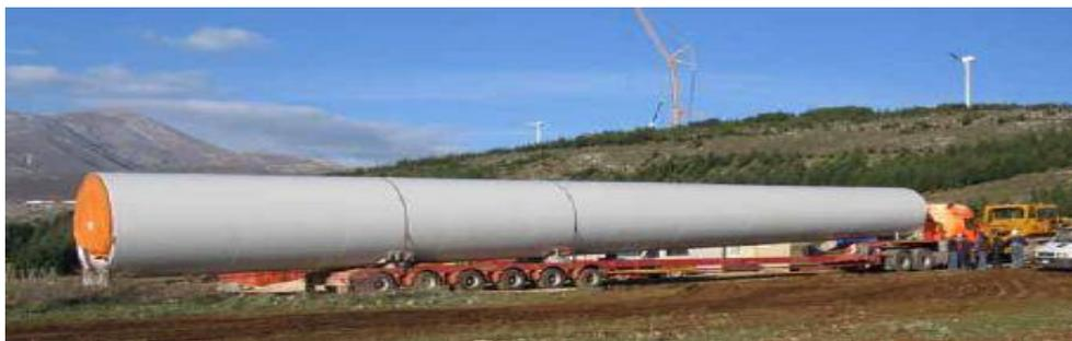
Fig.4: Mezzi per il trasporto di sezioni di torre
