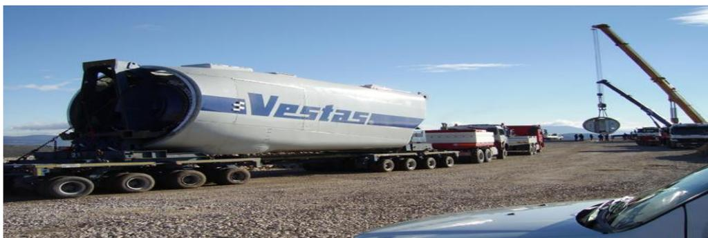
Fig.6: Mezzi per il trasporto della navicella.
