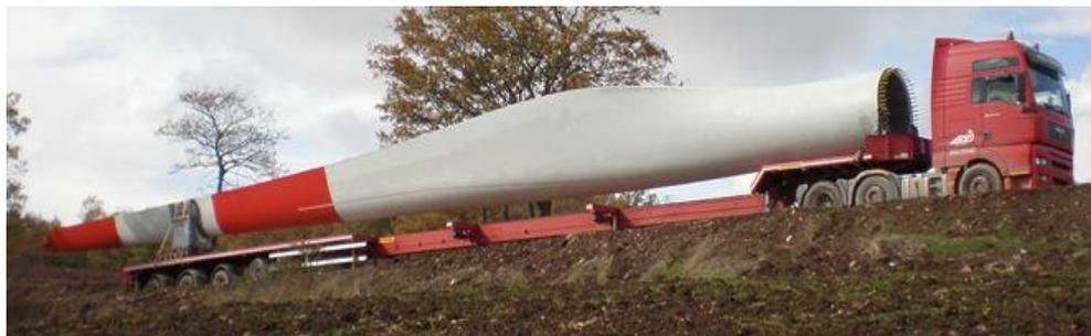
Fig.5: Mezzi per il trasporto della pala
