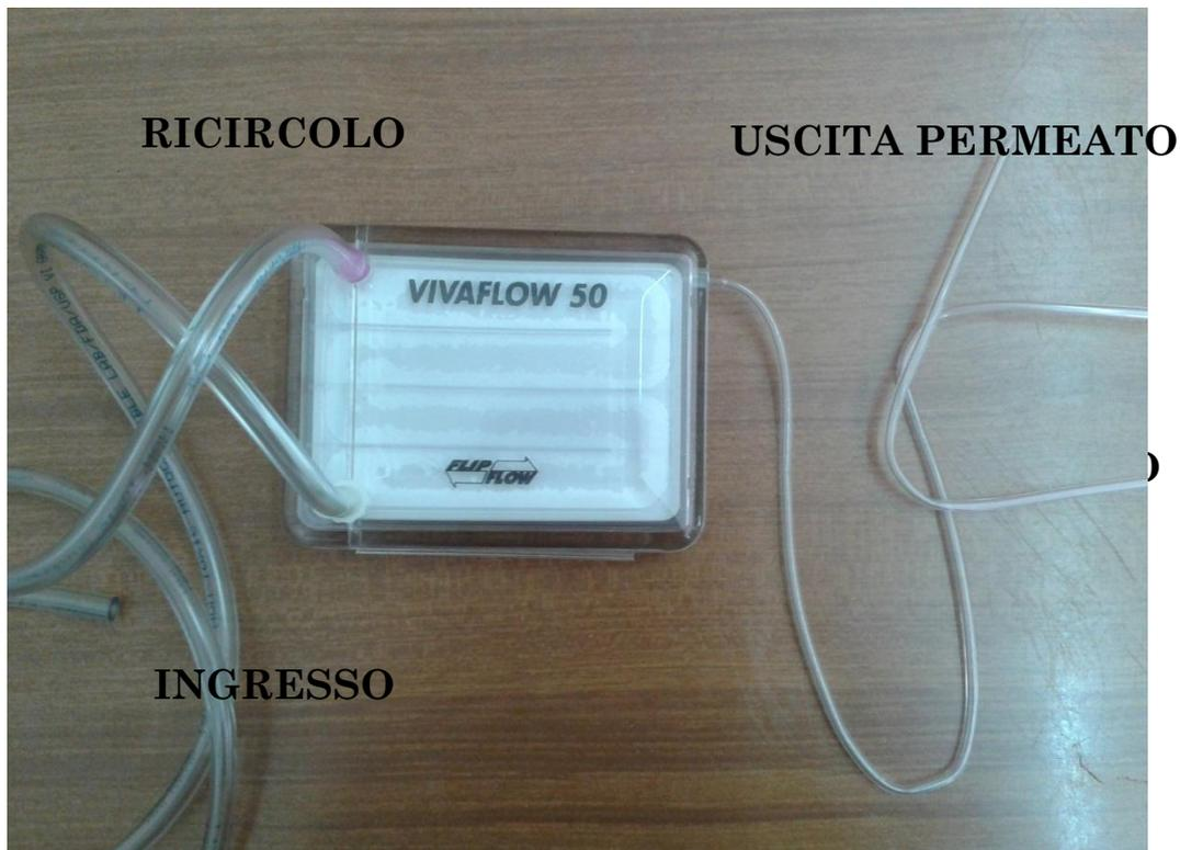
Essa viene eseguita mediante l'utilizzo di una pompa peristaltica in cui va collocato il tubo di ingresso, dall'uscita invece si recupera poi un permeato che sarà l'alimento della membrane con spessore minore subito successiva, mentre il retentato fuoriesce attraverso il ricircolo nell'alimento stesso, finché in esso non rimarrà solo in retentato stesso. A quel punto la filtrazione sarà giunta al termine.
