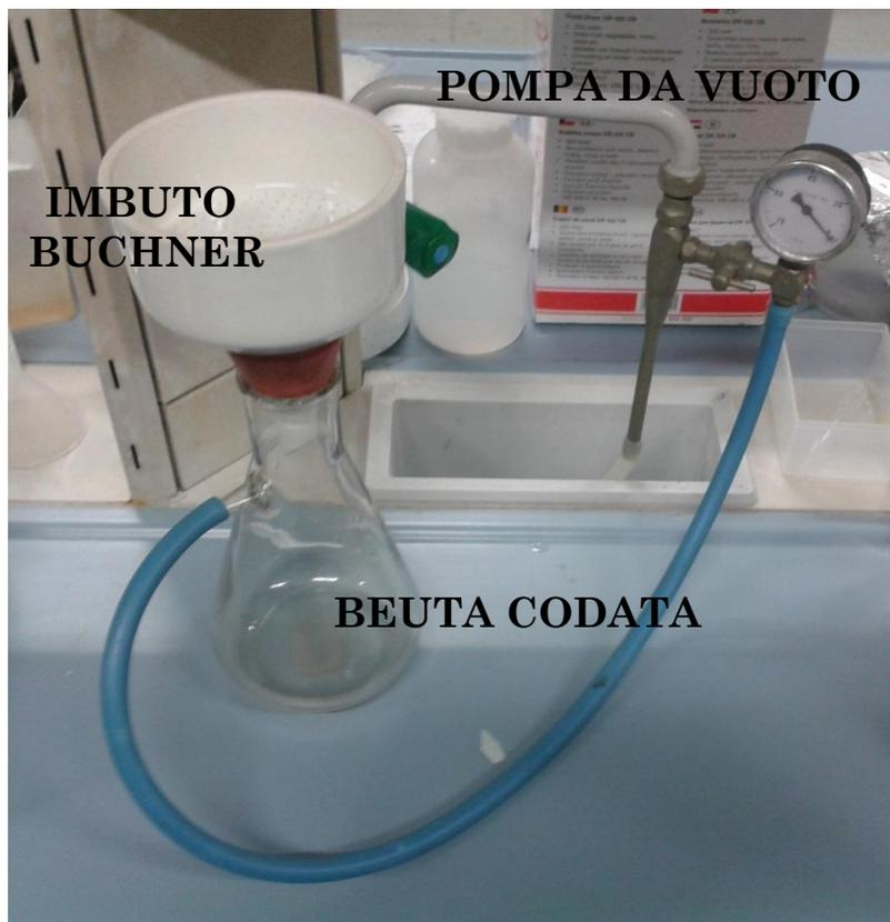
E carta da filtro con diametro dei pori di spessore pari a  $1,5 \mu\text{m}$ , al fine di rimuovere quei solidi sospesi che avrebbero portato al rapido intasamento della membrana.
