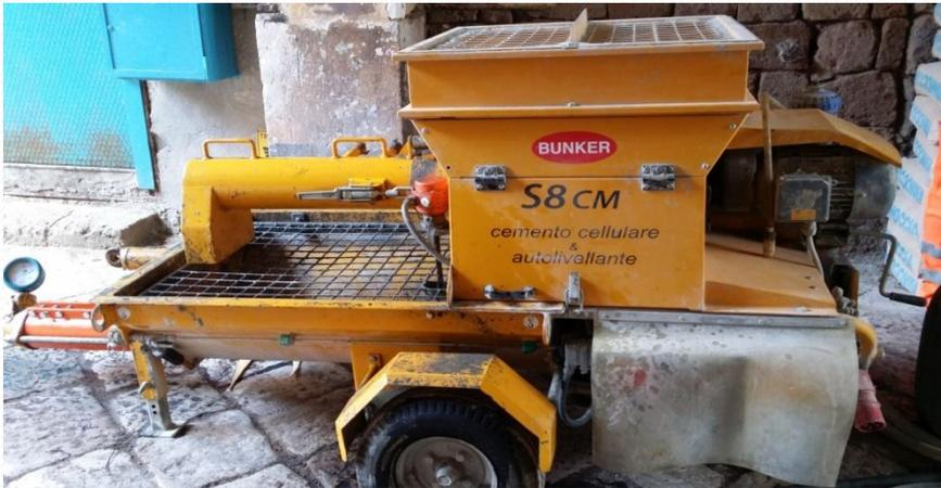
Ogni volta che il cemento cellulare veniva iniettato in foro, si effettuavano delle misure per il controllo delle proprietà.
