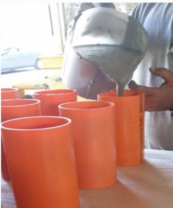
Si sono realizzati in seguito provini di cemento cellulare
