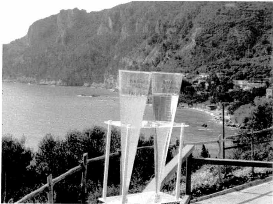
Figura 4 Comparazione tra il liquame in ingresso al depuratore (a sinistra) e il refluo effluente dal trattamento MBR (a destra)
