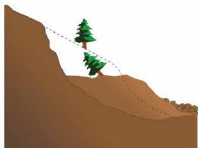
Figura 3-Frana per scorrimento rotazionale
