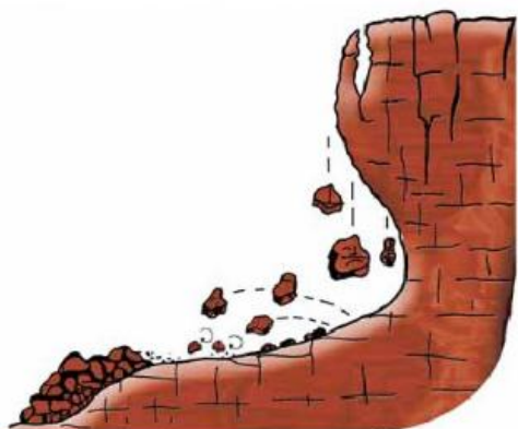
Figura 1- Frana per crollo
