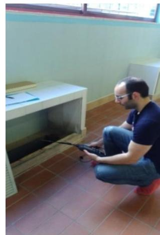
Figura 9 e): Lettura della velocità di immissione dell'aria
