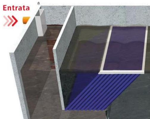
Particolare dei filtri a pacchi lamellari inclinati di 60°
