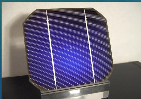
*Cella fotovoltaica in silicio monocristallino*
