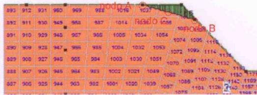
L'andamento del coefficiente  $k_h$  nel tempo, per effetto dell'applicazione di una storia temporale di accelerazioni al reticolo di elementi finiti, è stato determinato integrando lungo ciascuna superficie le componenti orizzontali dello stato tensionale agente alla base di ciascuna striscia ( $N_{ih}$  e  $T_{ih}$ ):
