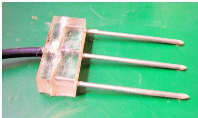
*Il numero e disposizione delle barre modifica la distribuzione del campo elettrico nell'intorno della sonda e la sensibilità della misura decresce rapidamente con la distanza dei conduttori.*
