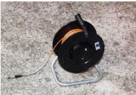
**SONDA GALVANOMETRICA:** è lo strumento utilizzato per la lettura del livello dell'acqua. E' composto da 2 conduttori collegati ad un'estremità agli elettrodi di una batteria, ed all'altra ciascuno con un cilindro di acciaio INOX. Quando il cilindro tocca l'acqua il circuito si chiude attivando un avvisatore acustico o visivo. Misurando la lunghezza del cavo calato nel tubo si trova la quota dell'acqua.
