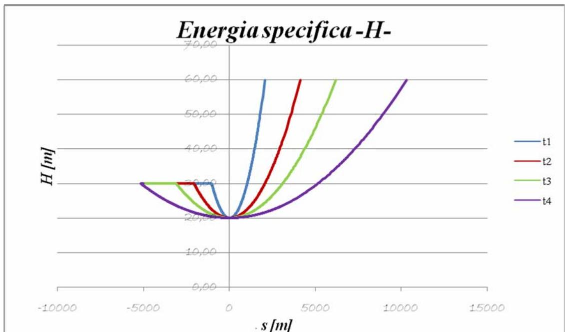
Abbiamo visto, in definitiva, un'applicazione del metodo di Ritter per risolvere le equazioni del Moto Vario, più precisamente le equazioni differenziali del De Saint-Venant, per un caso particolare come il crollo improvviso di una diga di ritenuta. Questa risoluzione in termini analitici del problema del Moto Vario, può anche essere sviluppata attraverso valori adimensionali delle altezze idriche, dello spazio e del tempo, rapportando tutto al valore di  $h_0$ .
