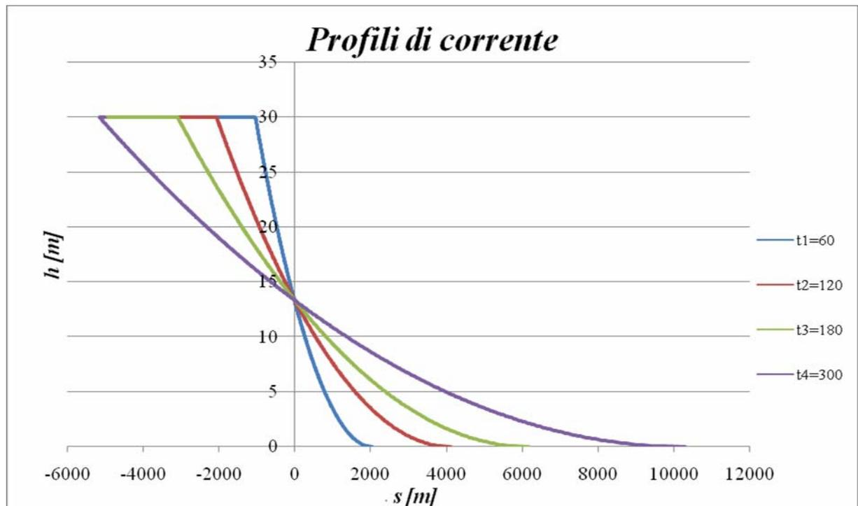
Risulta evidente come tutti i profili idrici di corrente passano per uno stesso punto notevole  $\frac{4}{9}h_0$  dal fondo del canale in corrispondenza della sezione ove si trovava la diga, che nel nostro caso specifico assume un valore pari a 13.333 m, per il quale risulta che la celerità  $C_h$  è nulla.
