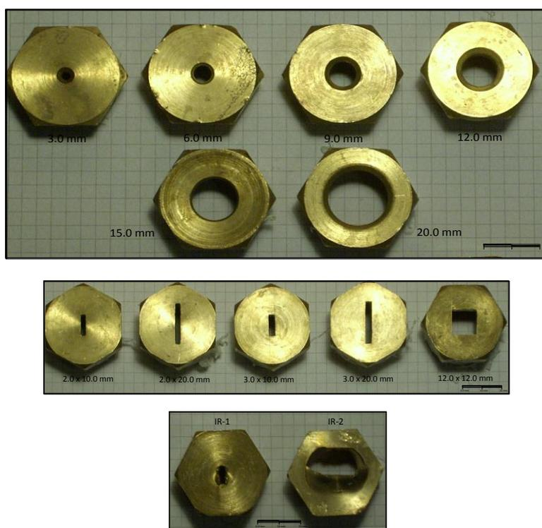
Figura 2 - Ugelli di forma differente utilizzati nelle prove per la simulazione delle perdite
