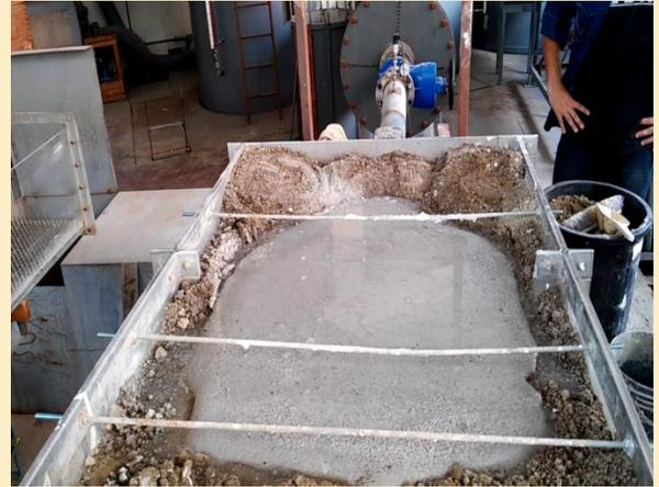
*Con la presenza del calcestruzzo cellulare, la perdita diffonde l'acqua in maniera uniforme senza interessare il terreno circostante.*
