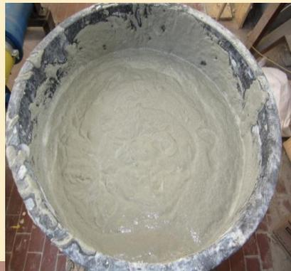
La prova sperimentale è stata condotta su un modello in scala disponibile presso il laboratorio di Idraulica e Costruzioni Idrauliche del DICEA, per simulare le reali condizioni di posa e di esercizio di una condotta in PEad interrata, affetta da una perdita localizzata. La trincea simulata è stata poi riempita con il calcestruzzo cellulare.
