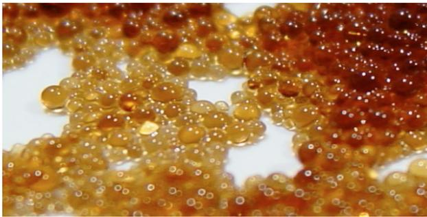
Resina a scambio ionico è composta da una matrice polimerica in cui sono intrappolati o inglobati ioni, disponibili per lo scambio ionico. Esistono numerosissime resine per lo scambio ionico, la maggior parte delle quali sono a base di polistirene a cui poi sono aggiunti gruppi funzionali in grado di catturare o rilasciare gli ioni.
