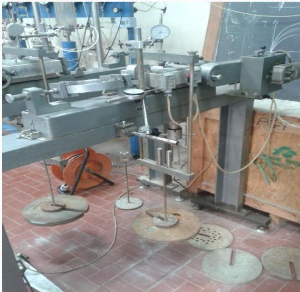
Si è imposta una tensione di confinamento pari a 50 kPa e si è applicato il carico parallelamente alla superficie di scorrimento ad una velocità di 0,012 mm/min.
