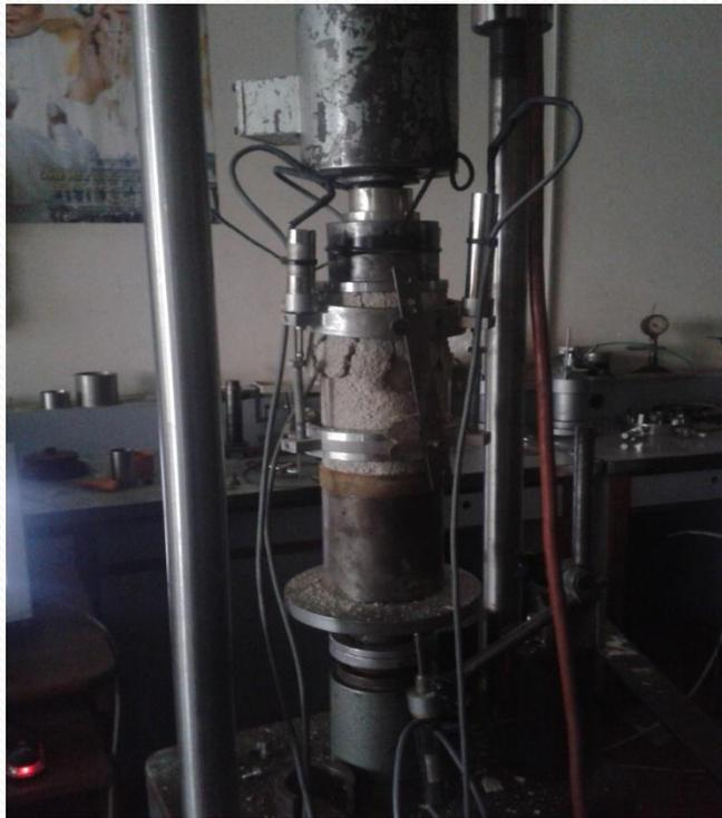
Il carico applicato è stato misurato utilizzando una cella da 100 kN; la velocità di avanzamento del pistone della pressa è stata impostata ad un valore di 0,002 mm/min.
