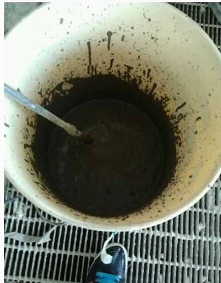
Il valore ideale di densità della boiaccia cementizia è di  $1,6 \text{ kg/ dm}^3$  ; per ottenere tale valore è stato miscelato un quantitativo di acqua e polvere di cemento in rapporto pari a 0,5.
