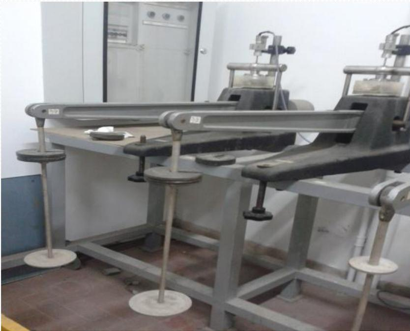
Si è imposto un carico verticale incrementato con progressione geometrica.
