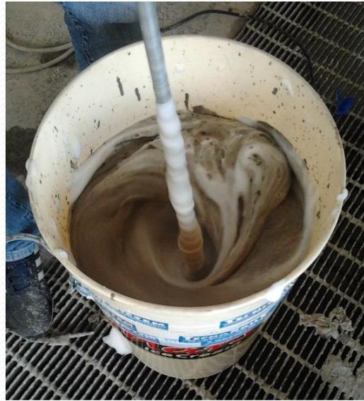
Sono state realizzate due miscele identiche con la sola differenza dell'aggiunta di fibre di polipropilene (pari allo 0.2% in peso).
