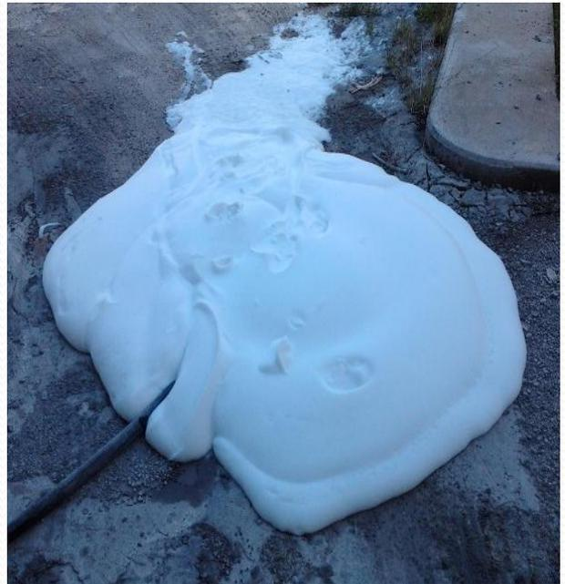
L'agente schiumogeno viene miscelato con l'acqua in una percentuale pari al 2% in volume. Insufflando aria ad una pressione di 2,6 bar si ottiene una schiuma con densità pari a 47,5 g/l.
