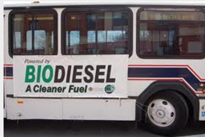
Il biodiesel è utilizzato nei motori diesel (senza apportare eccessive modifiche), generalmente sotto forma di miscela al 7% nelle autovetture, di miscela fino 30% negli autobus urbani e in forma pura in motori modificati.
