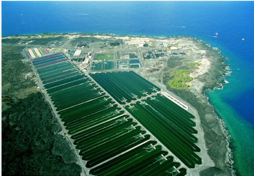
Un esempio di raceway ponds (Cyanotech Corp., Hawaii, USA)
