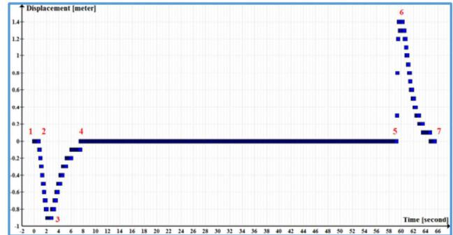
La variazione di pressione all'interno del pozzo, imposta a mezzo di una pompa a vuoto, ed il conseguente trasferimento di acqua tra l'acquifero ed il pozzo, e viceversa, permettono di valutare le caratteristiche di permeabilità dell'acquifero investigato.
