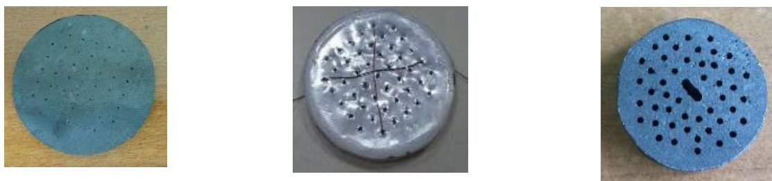
Figura 9: dreno elettrificato con PCL e grafite (sinistra); dreno in PCL e lamierino metallico (foto centrale); dreno in sola grafite (destra)
