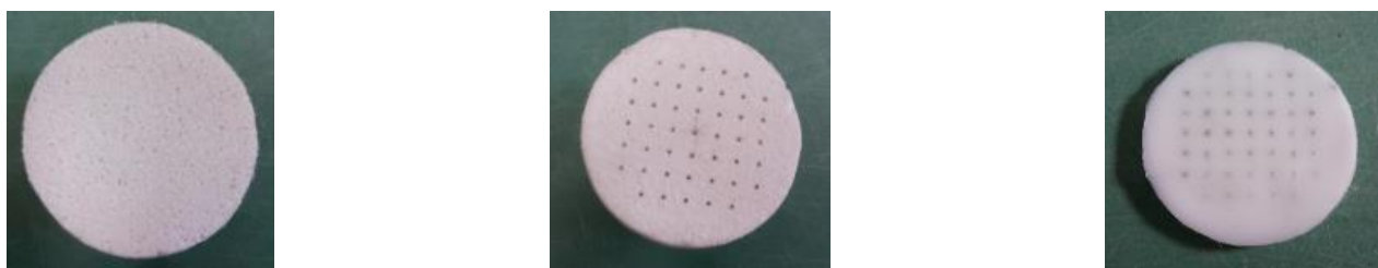
Figura 6: dreni in PCL e sale (sinistra); dreni in PCL e sale forati (foto centrale); dreni in solo PCL forati (destra)
