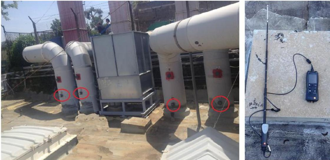
**Figura 2 – Anemometro a filo caldo utilizzato per eseguire la misura della velocità di aspirazione, nei fori situati alla base delle condotte di aspirazione, delle emissioni 15, 16, 23 e 25**
