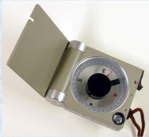
L'orientazione di una discontinuità viene misurata in campagna tramite la **bussola di Clar** che permette, con un'unica misura, di determinare sia il valore dell'immersione che quello dell'azimuth d'immersione.
