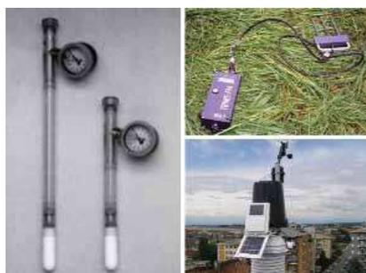
fig. 2.1 Strumentazione comunemente utilizzata nel monitoraggio di pendii di terreni parzialmente saturi
